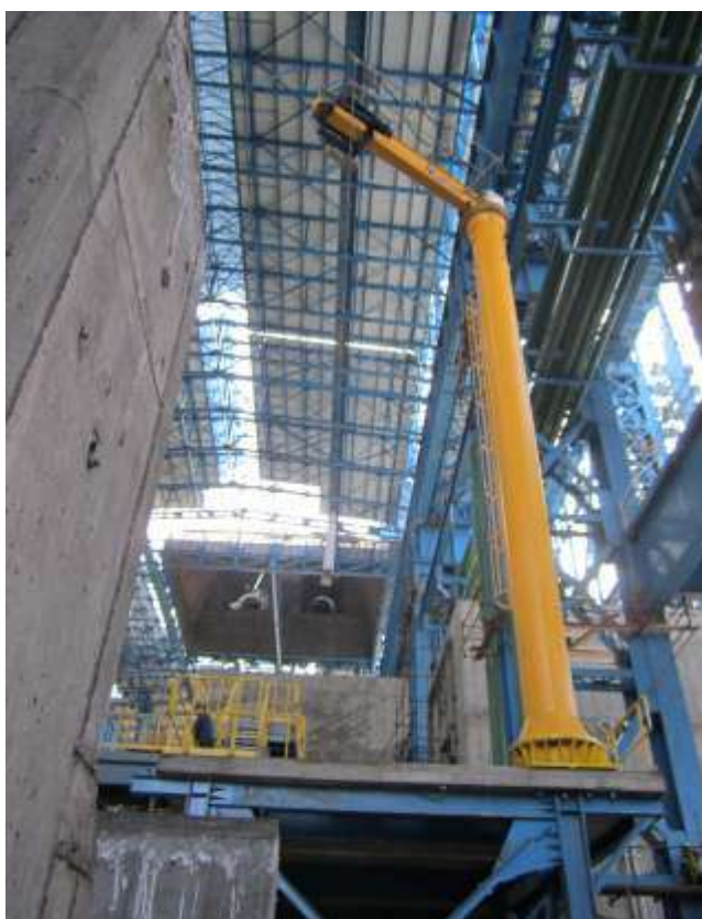
جرثقیل ستونی بازویی ۵ تن نصب روی پدستال ارتفاع ستون ۱۲ متر
